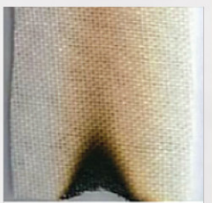
« نمونه خام و نمونه عمل شده با مواد تاخیرانداز شعله
