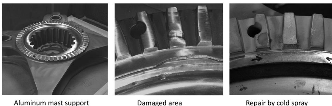
شکل (۱۱) تعمیر قطعه آلومینیمی مورد استفاده در هلیکوپتر
