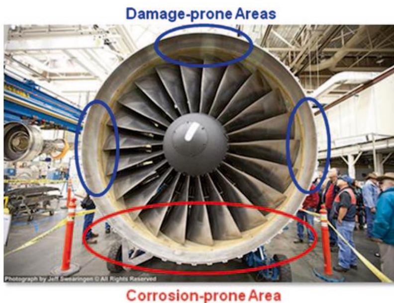
شکل (۱۲) مناطق مستعد به خوردگی در قسمت Fan case موتور هواپیما به دلیل تجمع آب
