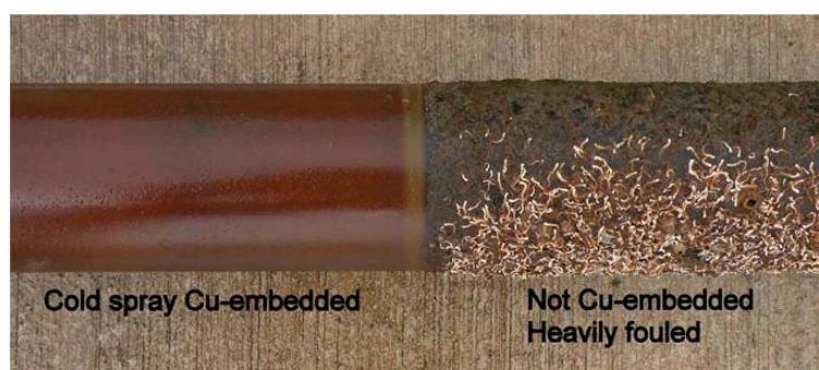
شکل (۲۰) مقایسه سطح پوشش‌دهی شده با مس به روش پاشش سرد و سطح بدون پوش از نظر تشکیل رسوبات بیولوژیکی
