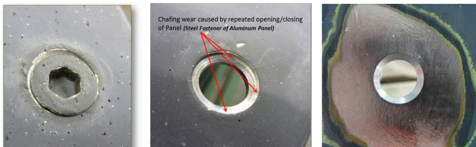
شکل (۱۰) تعمیر عیوب ایجاد شده در حفره‌های محل قرار گیری پیچ و پرچ در پنل
