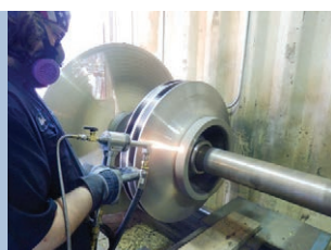
▲ قطعه‌ای از پمپ پوشش داده شده با روش HVOF مورد استفاده در صنایع پتروشیمی
