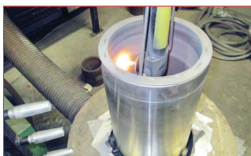
▲ پوشش‌دهی سطوح داخلی کمپرسور
