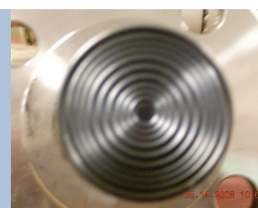
▲ تصویر سطح دیافراگم پس از هشت ماه کارکرد
